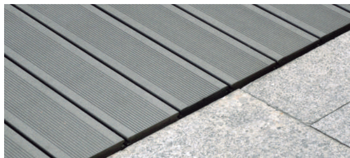
Instalar siempre con junta de 5mm entre lamas y de 15m con los extremos.
